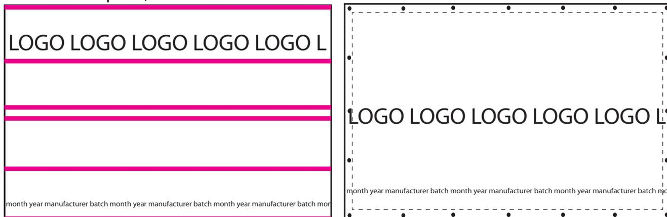
*Feuilles de plastique : à gauche avec des bandes de renfort, à droite avec des bords cousus et des œillets*
