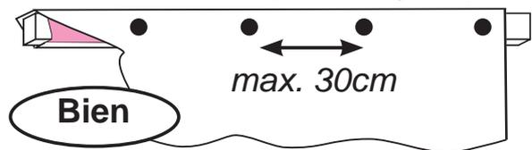
*Les points de fixation doivent être rapprochés : espacement de 30 cm maximum.*
