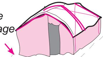
**Exemple:** Abri de plastique rudimentaire (sans parois) pour les climats chauds. Une structure d'urgence de ce type s'utilise en dernier ressort lorsqu'il n'y a pas d'autre solution. Elle est à améliorer dès que possible.
