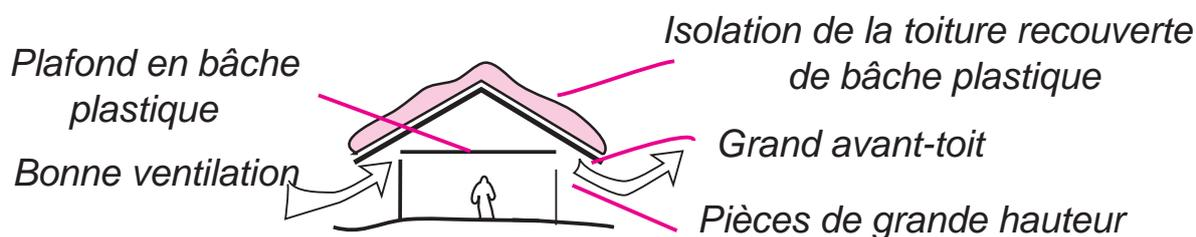
Caractéristiques d'un bâtiment conçu pour un climat chaud
